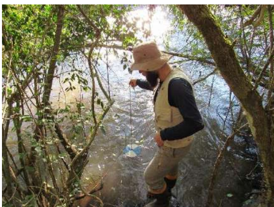
Figura 7.4: Aferição da transparência com Disco de Secchi P02 – 1º Campanha. Fonte: Construnível, 2020.
